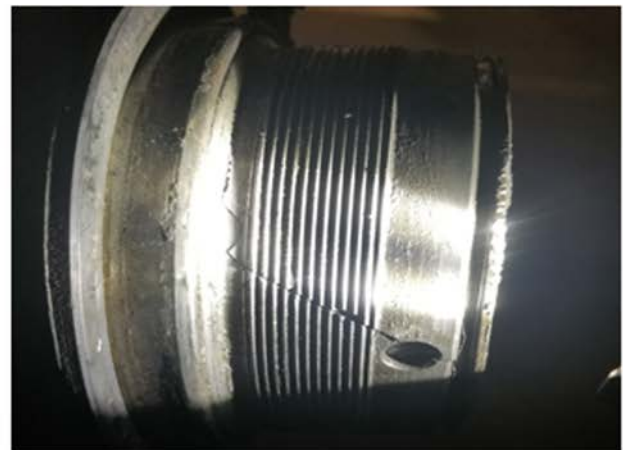
Gros plan de l'axe du train d'atterrissage principal, alors que l'écrou de l'axe est enlevé
