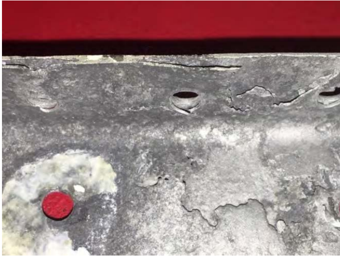
Fig. 2 : Gros plan de la zone corrodée montrant la profondeur et l'écaillage
