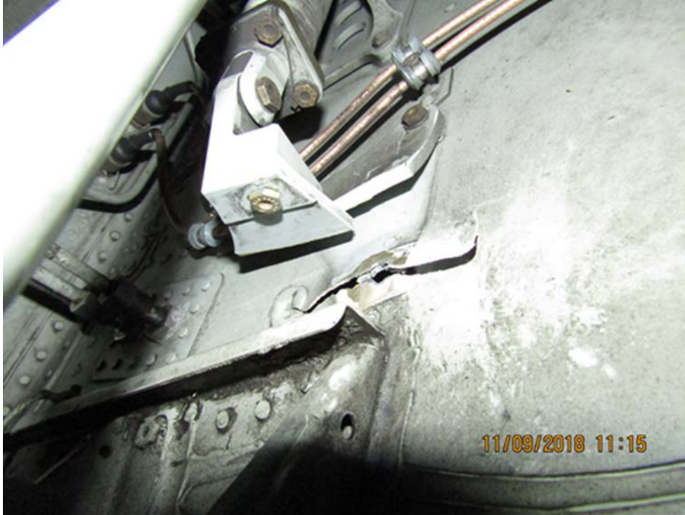
Figure 2 : Rupture de la ferrure vue de dessous démontrant les dommages de la pièce de fixation.
