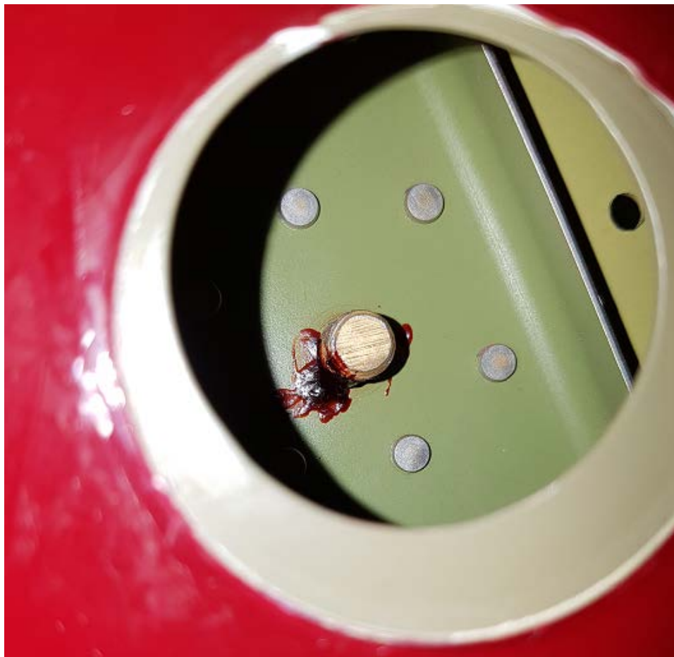
Image 2 – Écrou et rondelle manquants
