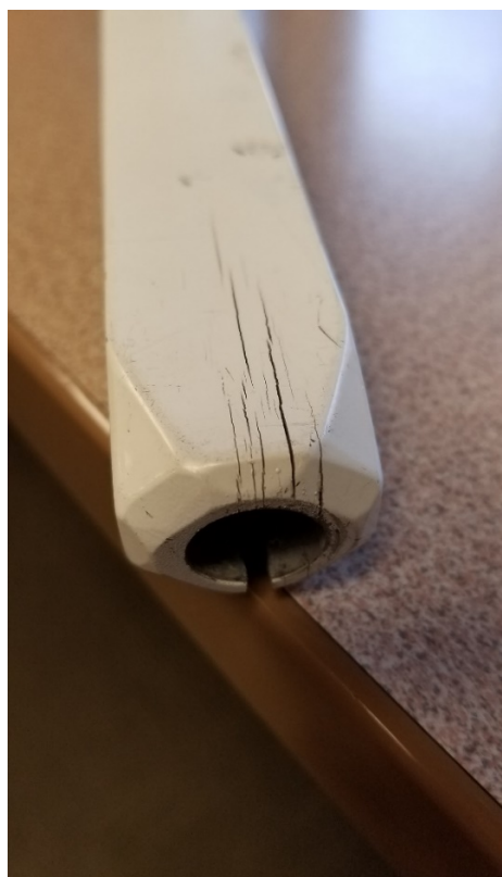
Figure 1 : Fissuration du levier des deux côtés
