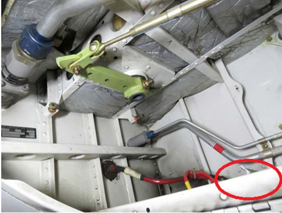
Photo 1 – Guignol dans l'état où il a été trouvé par le service d'entretien avant le retrait. Pièce brisée du guignol (encerclée) trouvée sur le sol de la cavité.
