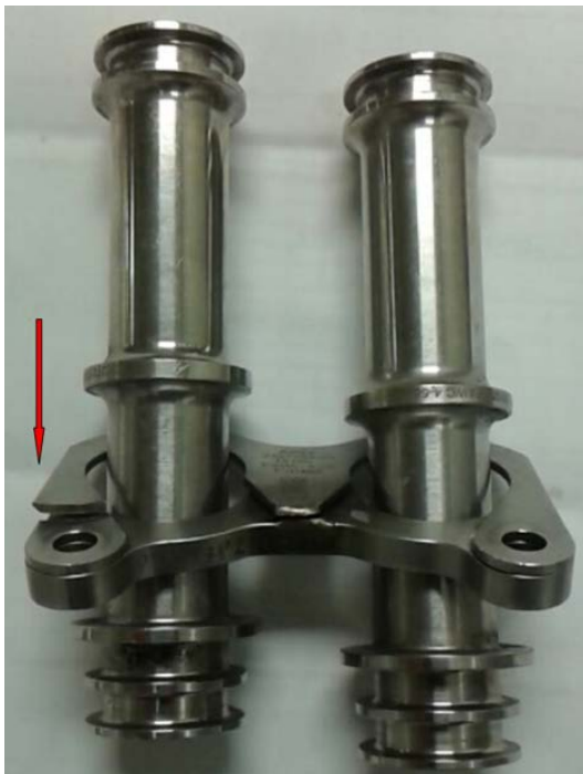
Photo 1 Ensemble de canalisation de transfert
