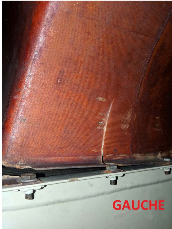
Fig 2 : Bord du conduit gauche arrière séparé Fig 3 : Conduit droit extérieur
