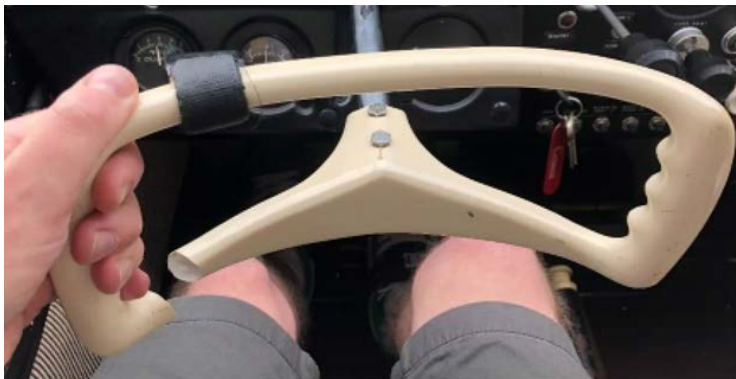
Volant de pilotage en plastique fendu
