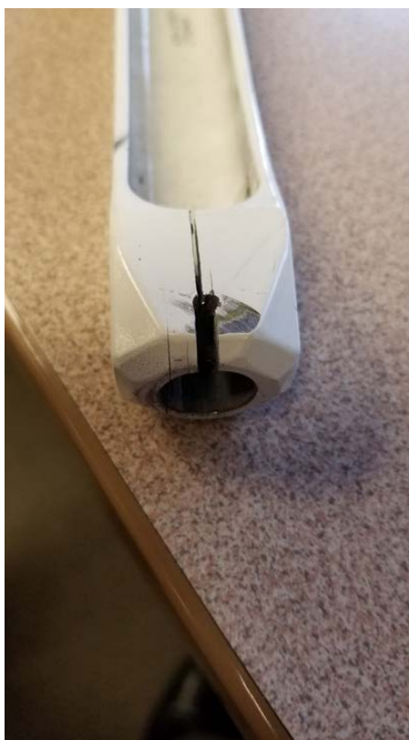
Figure 2 : Fissure du levier dans le trou de goupille conique
