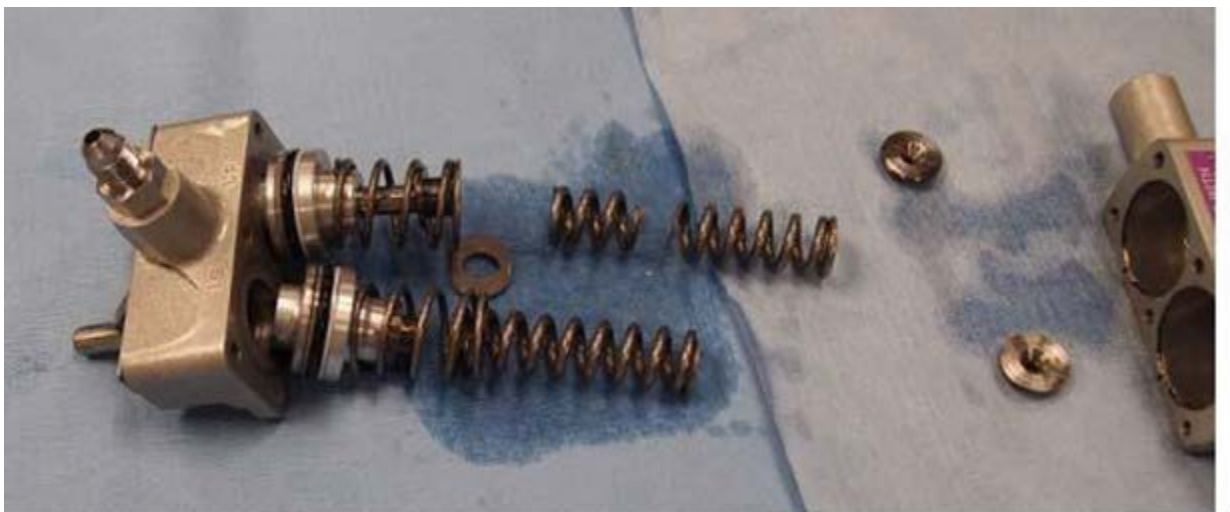
Fig. 3 : Gros plan du ressort rompu du répartiteur de freinage.
