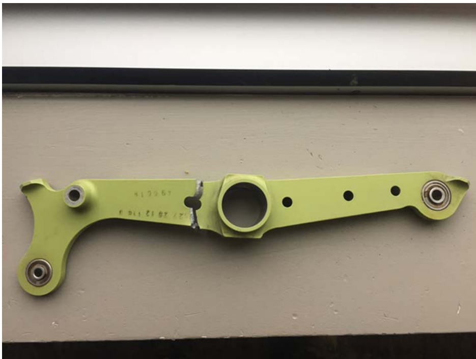
Photo 2 – Guignol démonté sur un établi. Fente évidente.
