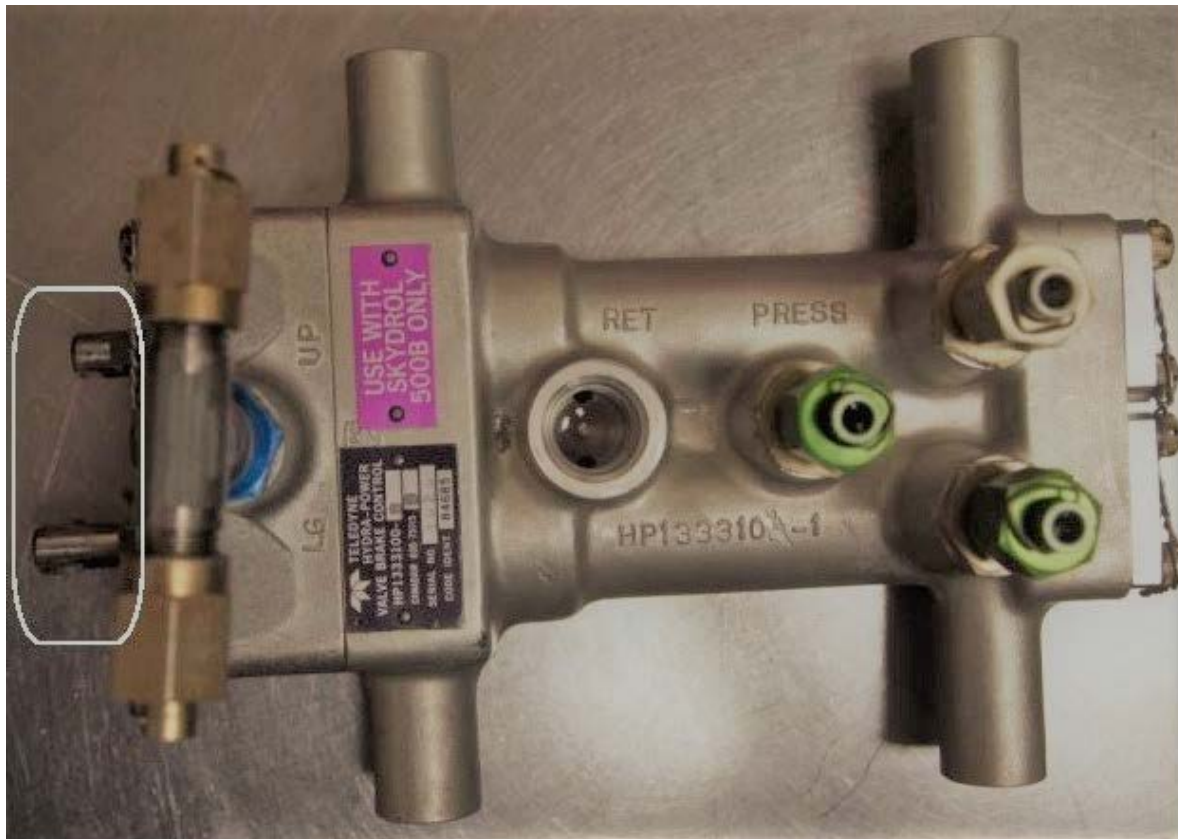
Fig. 1 : Répartiteur de freinage présentant un désalignement des pistons de puissance.
