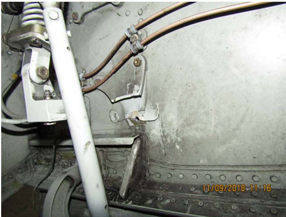
Figure 3 : Rupture de la ferrure vue de face démontrant les dommages de la cloison.
