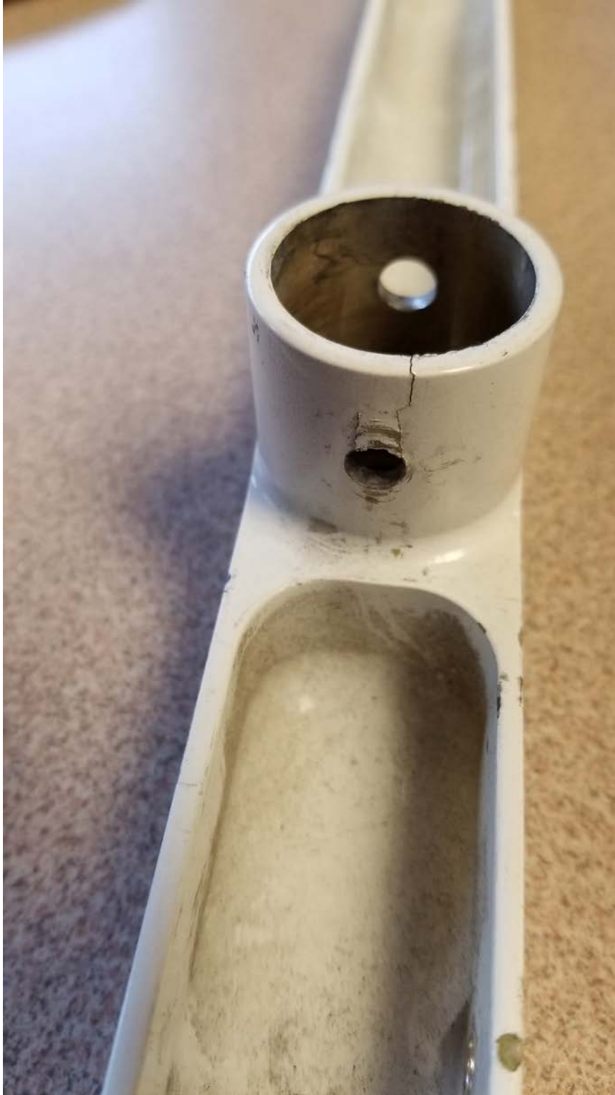
Figure 3 : Fissuration et contrainte au point de pivot
